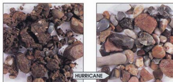
Lehmeinlagerungen aufgelöst und mürbe Steine zerrieben.
